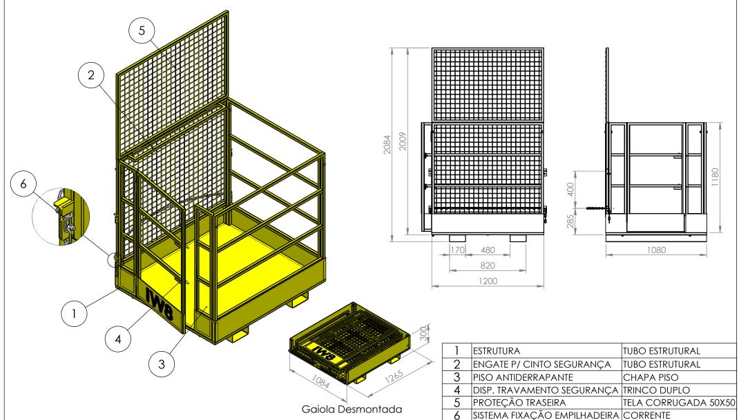
6990 GAIOLA P/ EMPILHADEIRA DESMONTÁVEL 1,08X1,20 Capacidade de Carga Acabamento: Pintura Eletrostática
